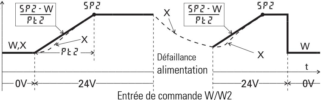
👉 Après le démarrage, la mesure est utilisée comme valeur de départ et la rampe se conforme à la formule et au comp. de démarrage. Si p.ex. X=W, la consigne **SP2** est atteinte après **Pt2**.
