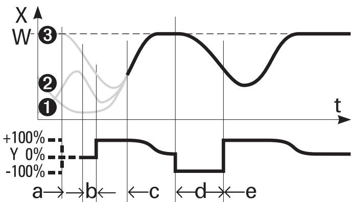
Bei ausreichender Reaktion der Regelstrecke verlaufen die Versuche erfolgreich, und neue Regelparameter werden ermittelt. Nach erfolgreicher Adaption verlöscht ADR, und der aktuelle Istwert wird angezeigt.
