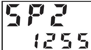
Drücken von **▲** oder **▼** verändert den Wert (je länger desto schneller). Die Änderung wird nach 2 s oder durch kurzes Drücken von **□** wirksam; **□** schaltet auf den nächsten Parameter weiter.
