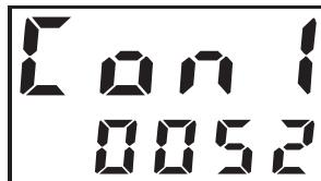
Drücken der Tasten **▲** und **▼** verändert den Wert von **Con1** (je länger desto schneller). Mit Drücken von **□** wird die Änderung wirksam und **Con2** wird angezeigt.
