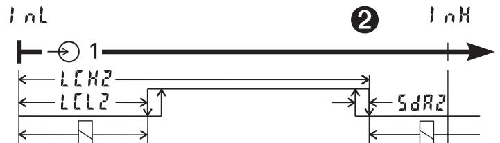
**Wirkungsweise relativer Limitkontakte LC1 / LC2 (z.B. für LC1, Ruhestrom ③, Arbeitsstrom ④)**
