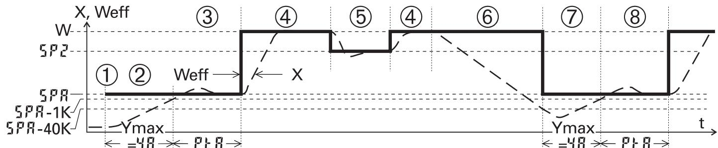
Nach dem Einschalten der Hilfsenergie (①) mit  $X < SPR < W$ , wird der Istwert zum Sollwert **SPR** (②) hin geregelt ( $Y_{max} = Y_R$ ). Ein Grad darunter startet die Haltezeit **PtR** (③). Danach wird auf den Sollwert W ausgeregelt (④). Ist auf den 2. Sollwert geschaltet, wird **SP2** geregelt (⑤). Lässt eine Störung (⑥) den Istwert > 40 Grad unter den Sollwert **SPR** fallen, so startet der Vorgang erneut (⑦ ⑧). **W2** blinkt bei laufender Anfahrtschaltung.
