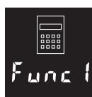
L'une de 7 fonctions mathématiques peut être choisie. Si l'on utilise des thermocouples, des Pt100 et des signaux standard avec linéarisation, la variable d'entrée de la fonction mathématique 1 est une température en °C ou °F. Dans toutes les autres gammes de mesure, la fonction 1 se rapporte aux valeurs pour  $w_0/w_{100}$  réglées dans le menu **Input**.
