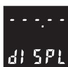
Le paramètre **Point** détermine le nombre des chiffres derrière le point décimal de l'affichage (0...4). , lorsque la valeur de sortie de **Func2** est affichée (état normal) voir également la p. 41 , commutateur **EE - d**.
