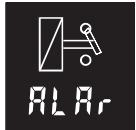
Für jedes der zwei Relais L1 und L2 können zwei Schaltpunkte eingestellt werden. Wird ein Schaltpunkt nicht benötigt, kann er abgeschaltet werden. Bei Geräteausführung ohne Relais, werden nur die Grenzwert-LEDs an der Gerätefront geschaltet.
